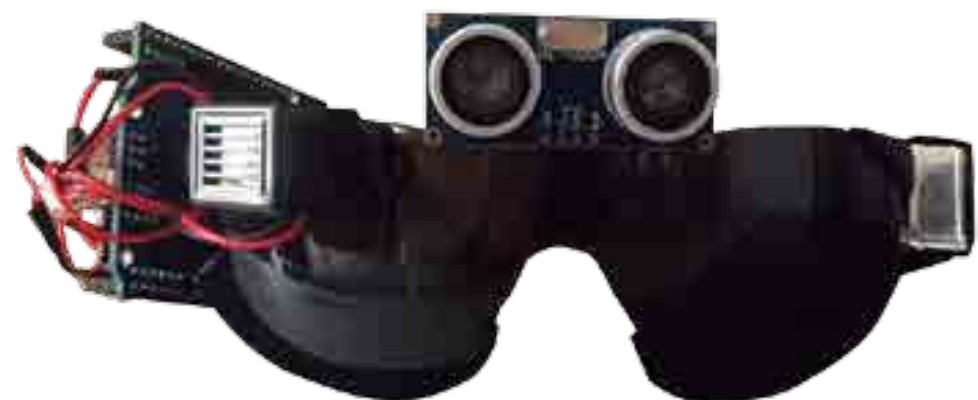
Óculos sensor, desenvolvido por aluno, que avisa às pessoas cegas quando há um obstáculo pela frente
